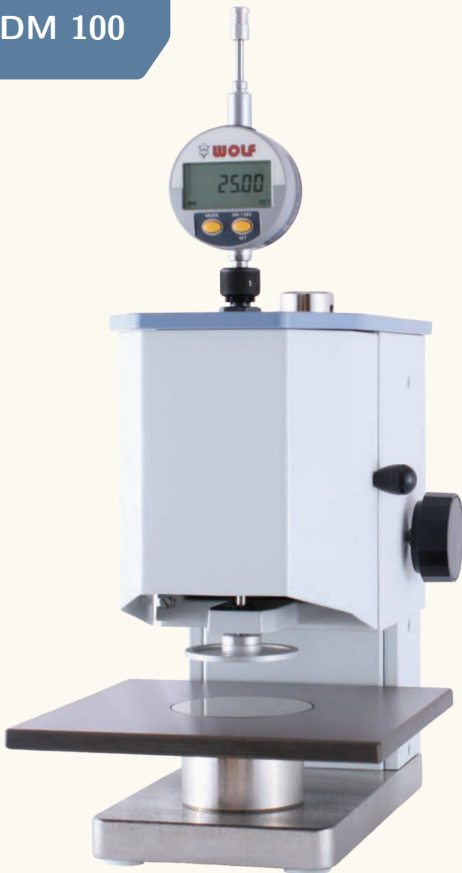
Modell DM 100 mit Messbereich 0 – 25 mm
