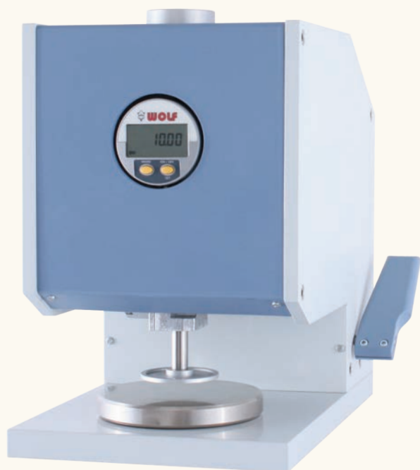
Modell DM 2000 mit Messbereich 0 – 10 mm
