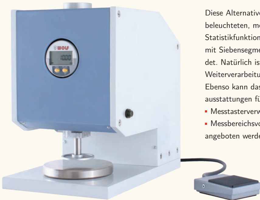
Modell DM 2005 mit Messbereich 0 – 10 mm und Fußtaster
